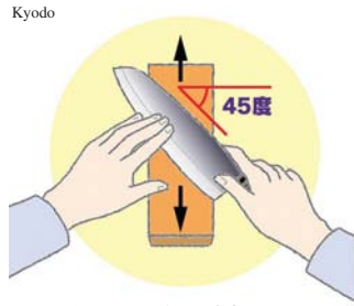
Kyodo 刃先を45度傾けると、包丁が安定する
